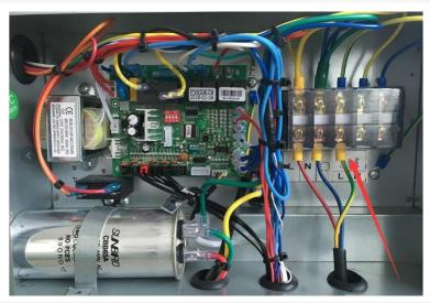
Nota: En el caso de los modelos trifásicos, el intercambio de dos fases puede hacer que los motores eléctricos funcionen en la dirección inversa, lo que puede provocar daños. Por este motivo, la unidad tiene un dispositivo de protección incorporado que rompe el circuito si la conexión no es correcta. Si el LED rojo sobre este dispositivo de seguridad se enciende, debe intercambiar las conexiones de dos de los cables de fase.
